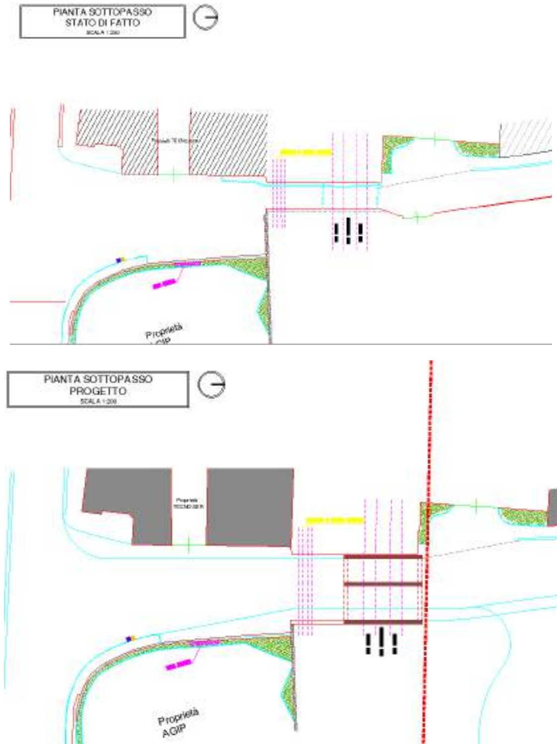
Figura 2: sottopasso ferroviario di via Lepanto nella configurazione attuale e quella di progetto
