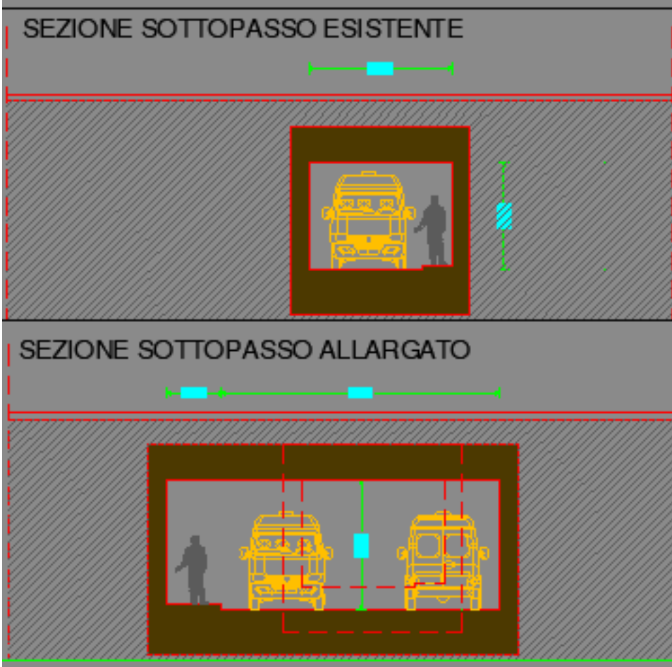
Figura 11: sottopasso ferroviario di via Lepanto nella configurazione attuale e quella di progetto
